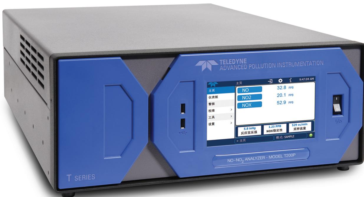
T200P型光解分析仪由我们的T200型化学发光法分析仪与有专利的(发明专利, ZL200380105162.1) 高效蓝光转化器(光解转化器)组成, 用于测量 NO/NO<sub>2</sub>/NO<sub>x</sub>。蓝光转化器能够提供效率接近钼转化器的二氧化氮特定转化。\*
