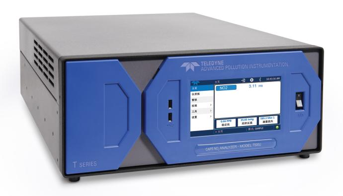
T500U型NO<sub>2</sub>分析仪是二氧化氮测量的重大突破。它使用腔衰减相移光谱技术,能够进行高精度、实时、连续、直接的二氧化氮测量。
