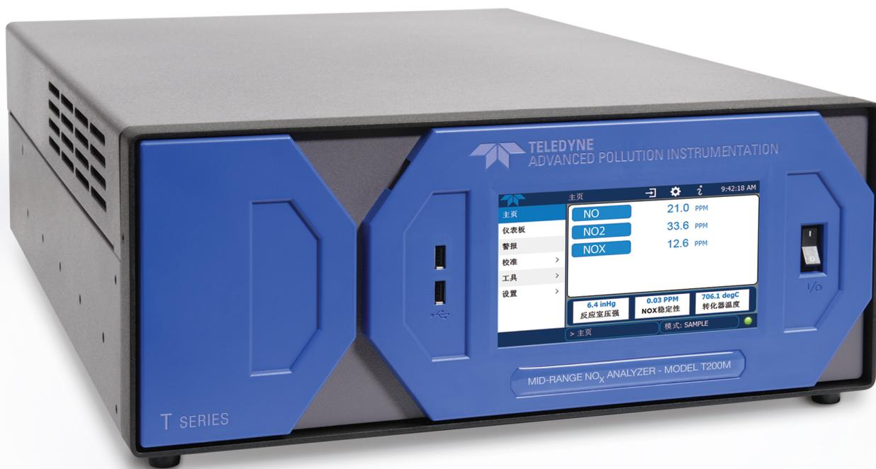
T200M型中量程化学发光法NO/NO<sub>2</sub>/NO<sub>x</sub>分析仪采用通过验证的化学发光检测原理，结合先进的电子元件，可精准可靠、连续地进行烟气监测及应用在其它合适场合。T200M也可安装可选的内置顺磁法氧气测量模块或红外吸收法二氧化碳测量模块用于氧气或二氧化碳监测，能够大大降低安装整合成本和运行成本。
