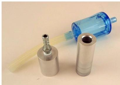
**Figure 4-1. Leak-Check/Flow-Audit Adaptor Kit**
