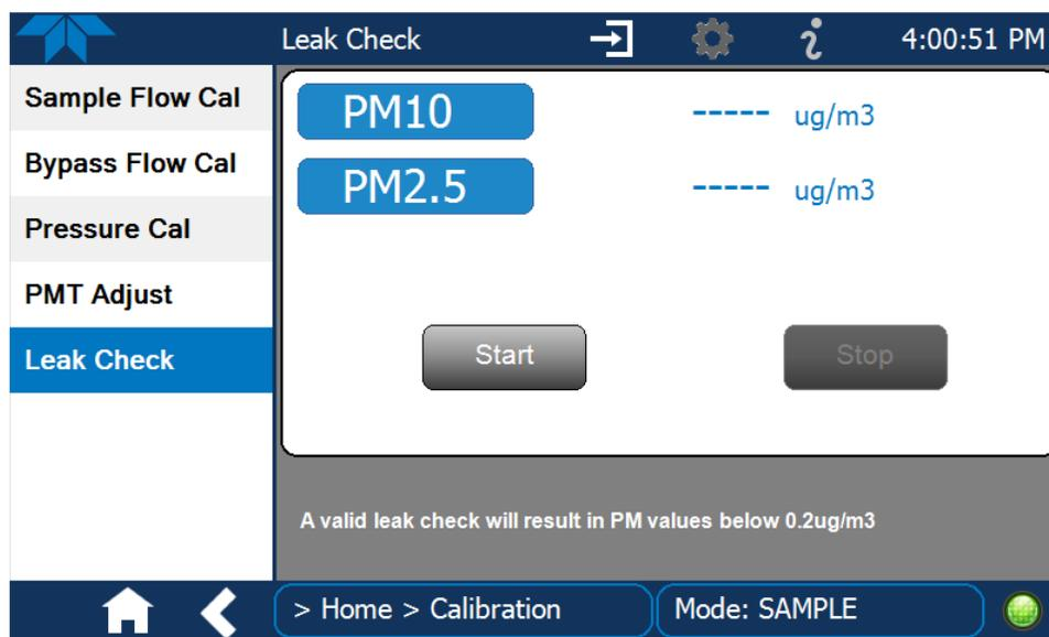
Figure 4-6. Leak Check Menu
